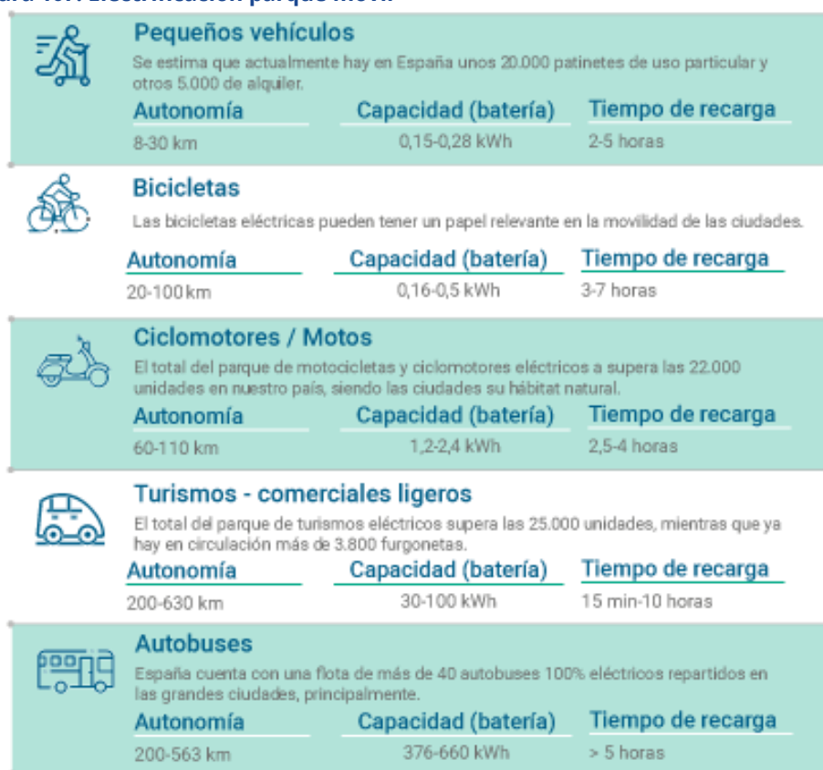
Figura 107. Electrificación parque móvil
